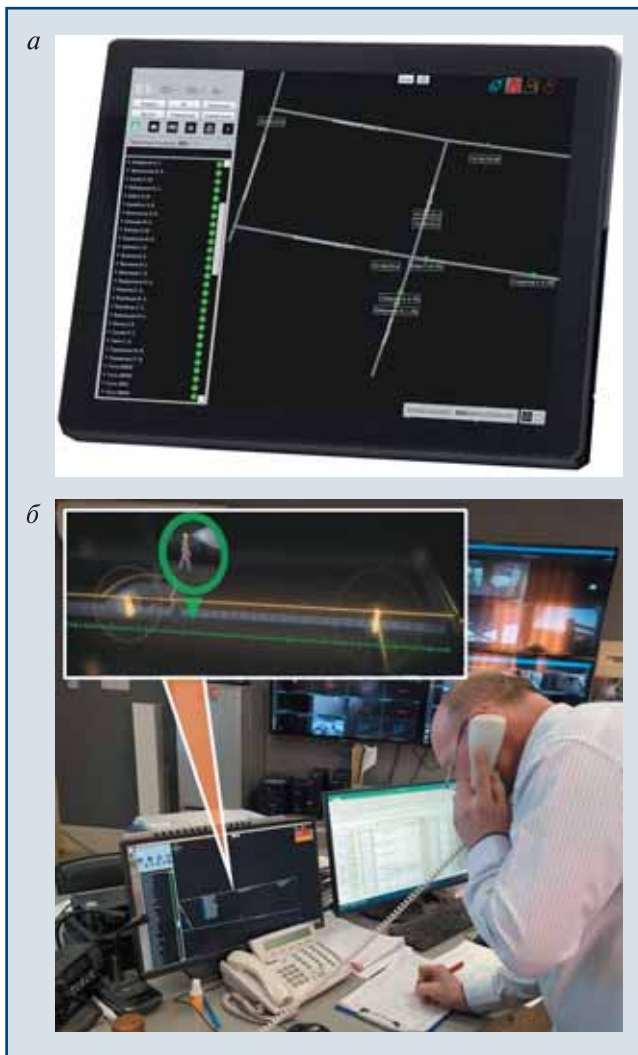
▲ Рис. 2. Система SBGPS (отображение местоположения людей на схеме горных выработок):
