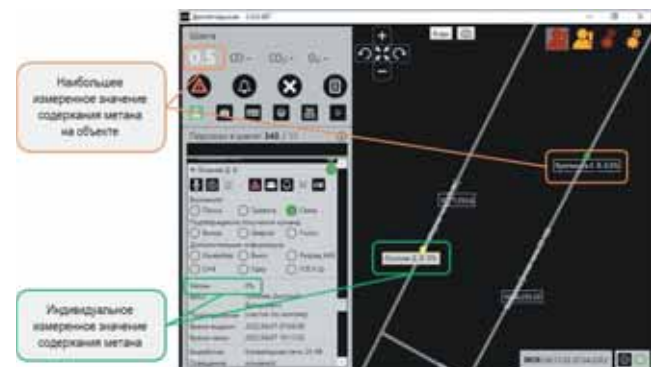
▲ Рис. 3. Порядок отображения на схеме горных выработок текущих значений концентрации метана в местах нахождения людей
